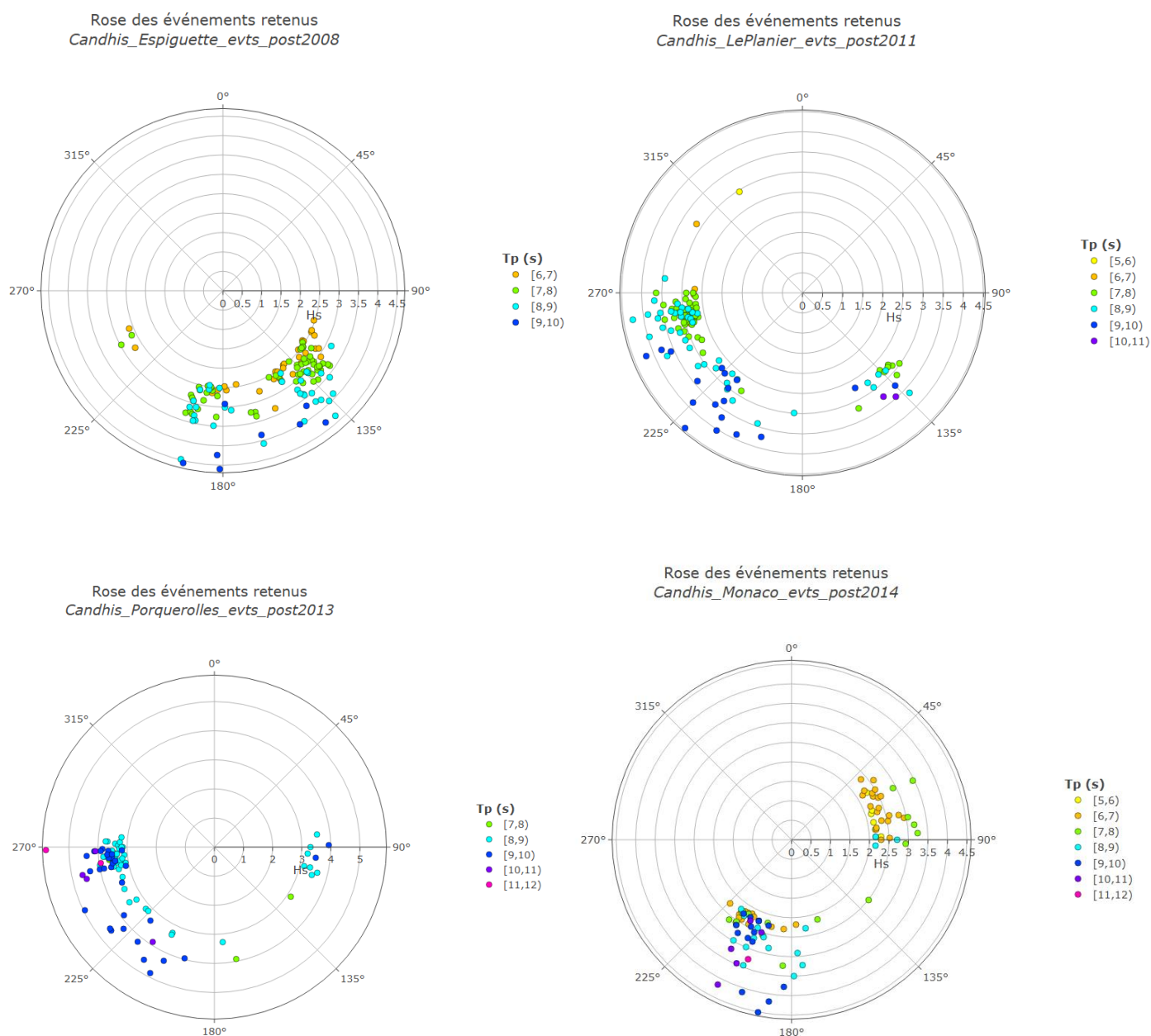
Figure 5 : Rose des houles des événements de coups de mer pour les 4 houlographes Candhis (Porquerolles, Monaco, Espiguette, Le Planier)
