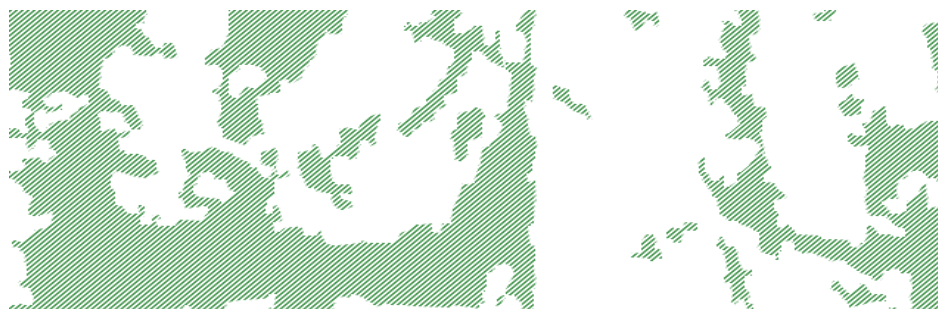
Étape 1 : Extraction des polygones « zone arborée » (surface > 5 000 m 2 ) puis lissée pour être compatible avec une échelle du 1/10 000 environ.
